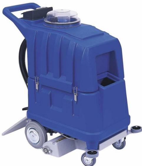
**Elite-Silent** est un injecteur extracteur compact pour moquette et carrelage à traction manuelle. La machine lave, brosse et sèche une bande de 50 cm de moquette, jusqu'à 500 mètres carrés dans une heure, en marchant en avant. Le moteur à 3 étages à **haute dépression** permet d'obtenir un excellent essorage dans un temps très court.
